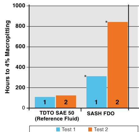
El fluido probado SASH FDO excede el fluido de referencia. El test se paró antes de que se alcanzara el límite de 4% de micropitting.
